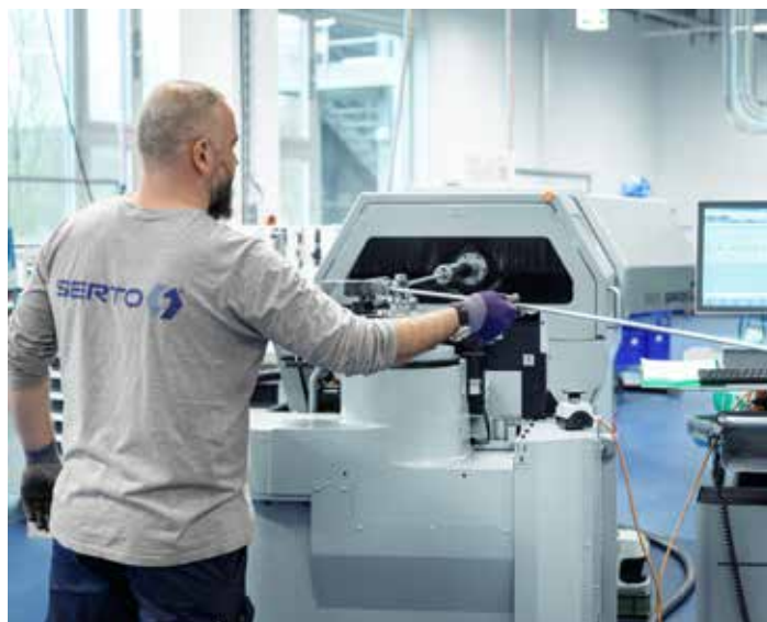
Rohre werden an der Maschine präzise gebogen.
