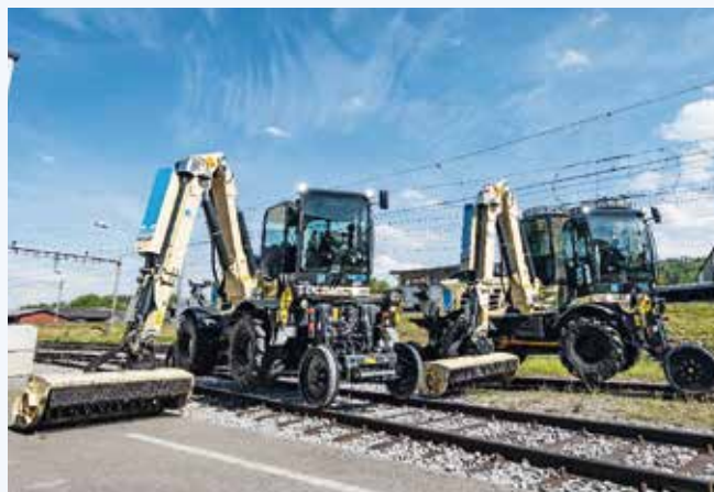
Neue Zweiwegeböschungsmäher für Schiene und Strasse.
