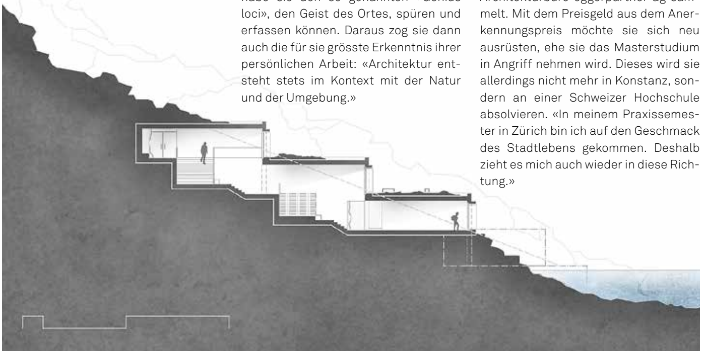
Der Querschnitt hebt die Besonderheit des Gebäudes hervor. Die vier Ebenen sind in das massive Gestein gehauen, welches auch im Gebäudeinnern präsent bleibt.
