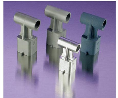
Das Bild zeigt ein Automobilbauteil in den verschiedenen Fertigungsstufen – vom Spritzgussteil bis zum Fertigteil.
