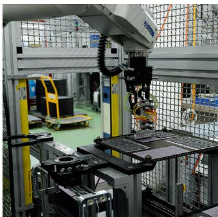
Vollautomatisierter Spritzprozess mit einem 6-Achsroboter.
